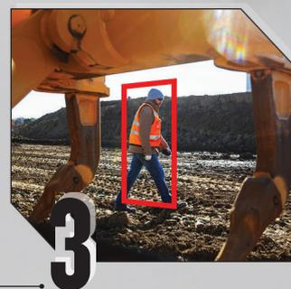
車両後方で人を検知した場合、警告音が鳴ります。検知した人との距離に応じて、画面表示や警告音の頻度と大きさが変わります。
