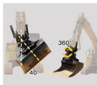
左右40°のチルトと360°旋回を可能にすることで車両の向きや傾きによらず、施工面とパケットの向きを合わせることができます。自由度の高い動きが多彩な作業を可能にします。
